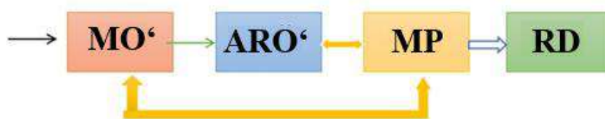
7-rasm. Raqamli mikroprotsessorli voltmetr sxemasi
