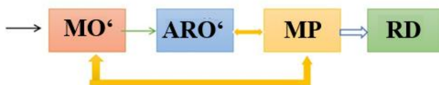
7-rasm. Raqamli mikroprotsessorli voltmetr sxemasi
